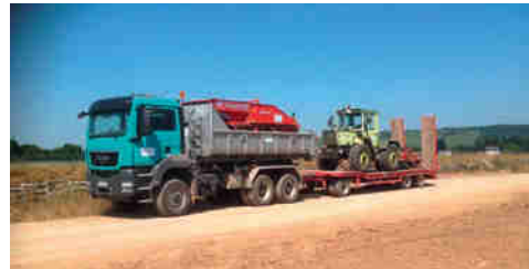
Gespann LKW mit Abrollcontainer und Tieflader
