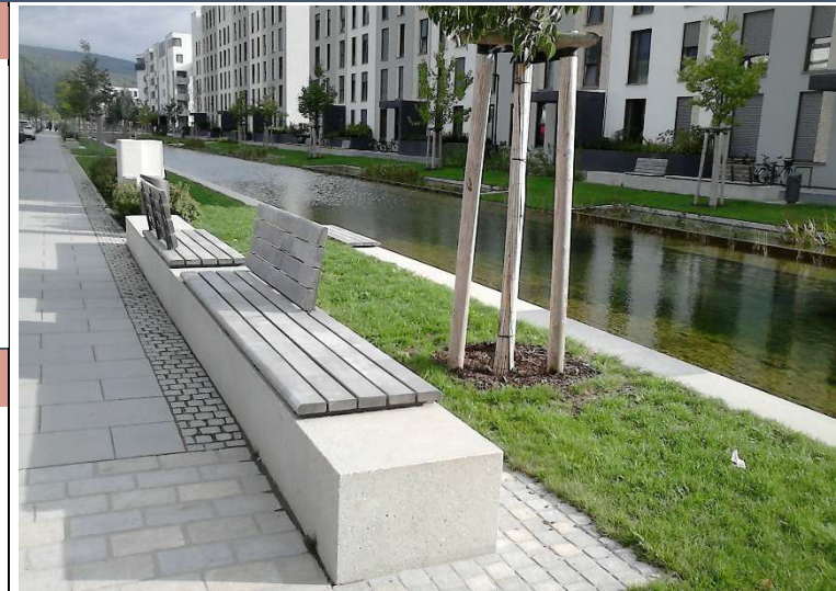
Bild: Wasserfläche aus gesammeltem Regenwasser, Bahnstadt Heidelberg (© S.Barden)
